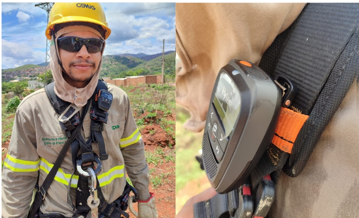
Figura 3 - Microfone bluetooth instalado no cinto de segurança.
